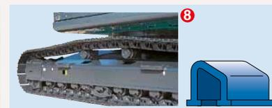
8 ● Diseño especial del bastidor de orugas se limpia fácilmente de barro.
