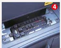
4 ● Caja de fusibles de fácil acceso con fusibles diferenciados, fácil de localizar averías.
