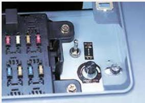
Si surgen problemas inesperados con el sistema de control de ITCS, la máquina se puede seguir operando con el sistema de aceleración de emergencia. Modos de excavación también se cambian automáticamente a un sistema de emergencia para que la excavación pueda continuar temporalmente hasta que una persona de servicio venga para reparar el sistema primario.
