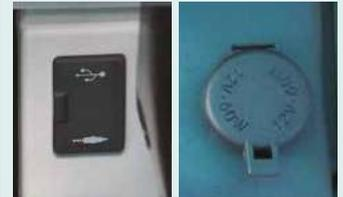
Conexión USB /Salida de 12V
