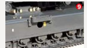
● Diseño especial del bastidor de orugas se limpia fácilmente de barro.
