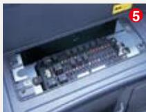
● Caja de fusibles de fácil acceso con fusibles diferenciados, fácil de localizar averías.
