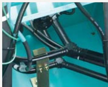
Rigurosa búsqueda de la pérdida de presión se llevan a cabo en todos los componentes de las tuberías hidráulicas, desde el carrete de la válvula de control a los conectores. Este régimen, combinado con el uso de una bomba de alta eficiencia, reduce la pérdida de energía a un mínimo.
