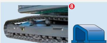
● Diseño especial del bastidor de orugas se limpia fácilmente de barro.
