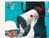
El elemento de gran capacidad, cuenta con una estructura de doble filtro que mantiene el motor en marcha limpio, incluso en entornos con mucho polvo.
