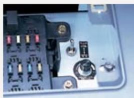
Si surgen problemas inesperados con el sistema de control de ITCS, la máquina se puede seguir operando con el sistema de aceleración de emergencia. Modos de excavación también se cambian automáticamente a un sistema de emergencia para que la excavación pueda continuar temporalmente hasta que una persona de servicio venga para reparar el sistema primario.
