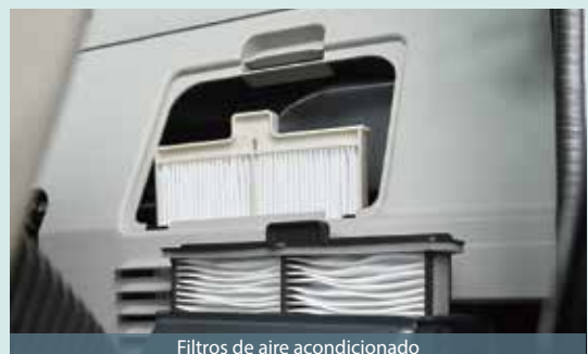
Filtros de aire acondicionado
