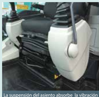
La suspensión del asiento absorbe la vibración
