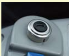
Llave de ignición de fácil acceso, fácil de encendido y protección de goma contra la humedad y la congelación
